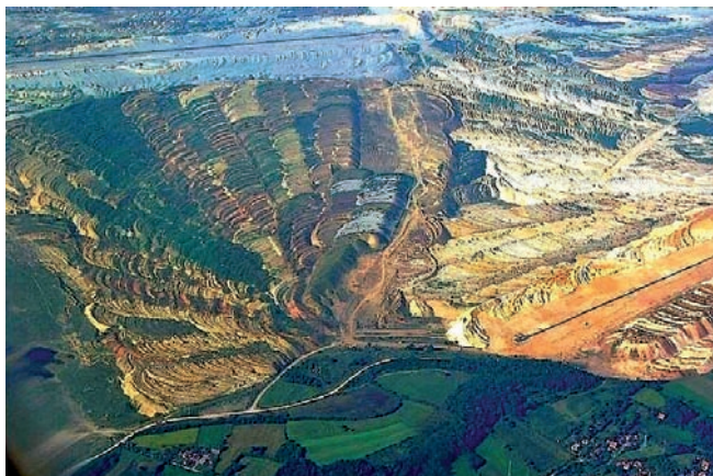
Ilustracija 2 Površinski kop bazena Kolubara, odakle se lignitom opskrbljuju elektrane u sastavu TE Nikola Tesla
