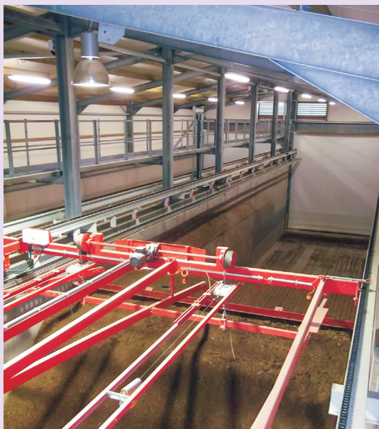
Rješenje transportnog sustava u skladištu goriva
