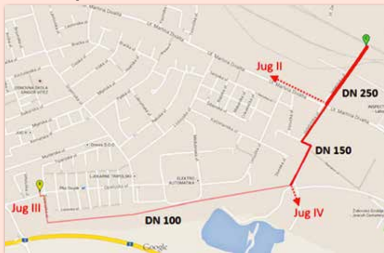
▼ Ilustracija 7 Prikaz budućeg priključnog vrelovoda za kotlovnice Jug III
